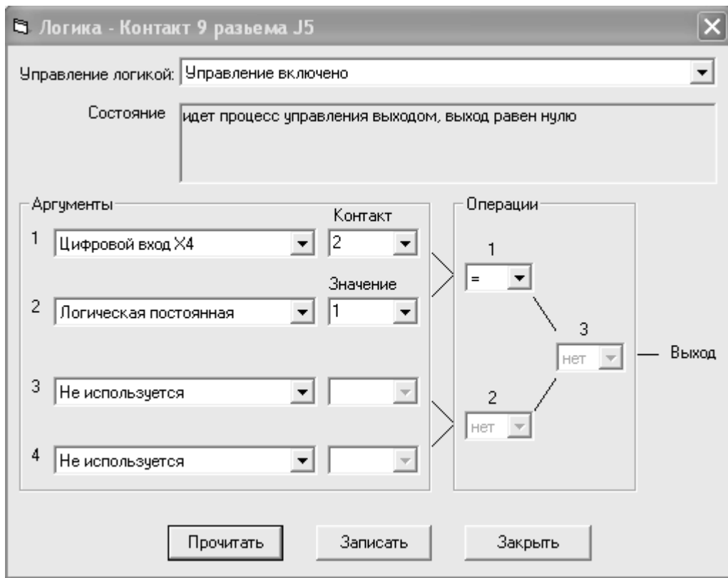
Рис. 11-21. Конфигурирование Логики: при изменении значения на контакте X4:2 равным "1" ("on") выход на контакте 9 разъёма J5 устанавливается в состояние "1" ("on")
