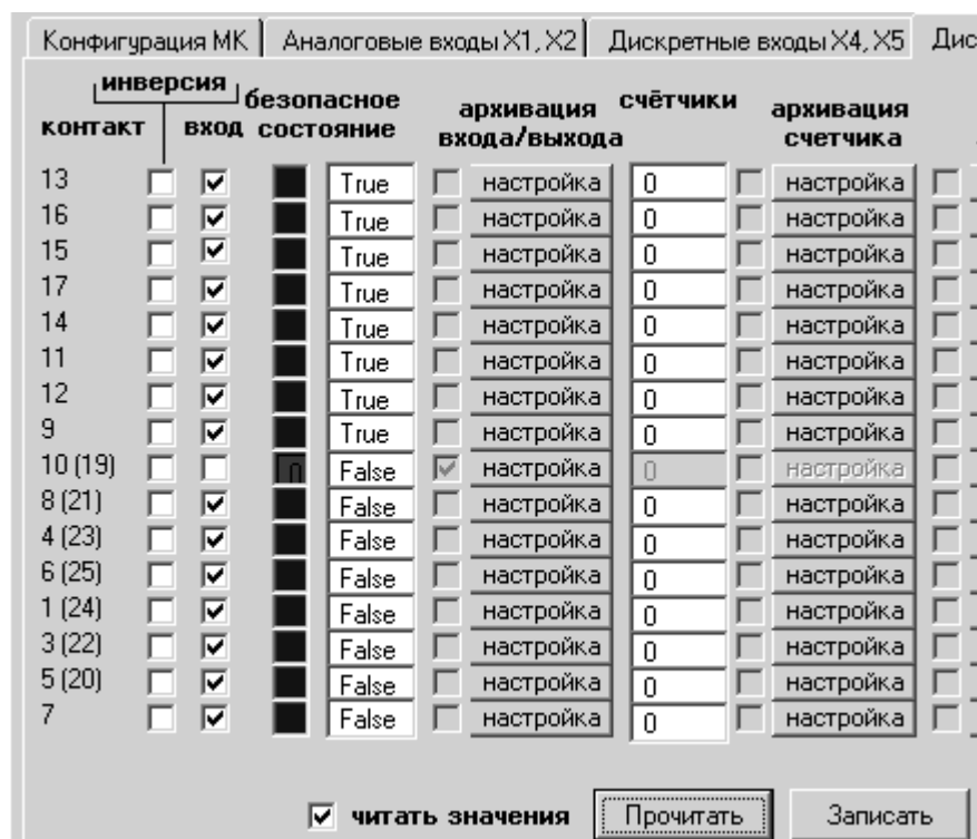
Рис. 13-9 Проверка заданной архивации на выходе J5:10 (19)
